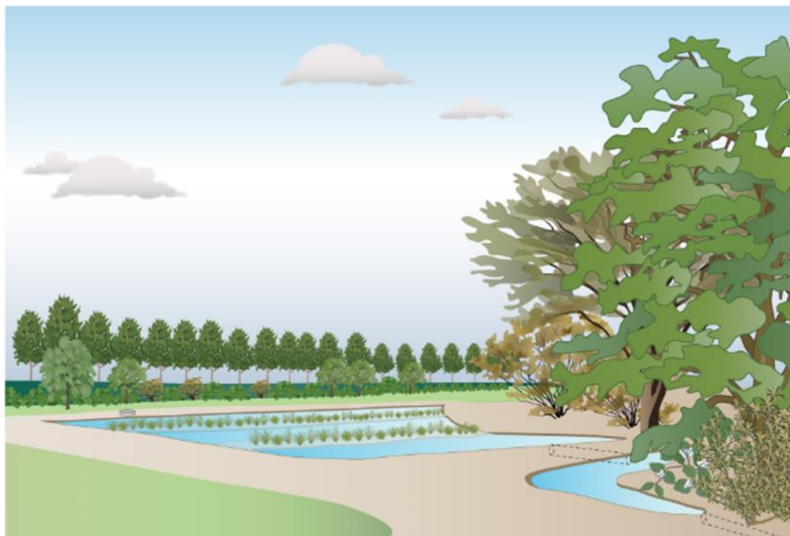
Figur 4. Principskitse af design for konstrueret vådområde med overfladestrømning (Kjærgaard og Hoffmann, AU).
