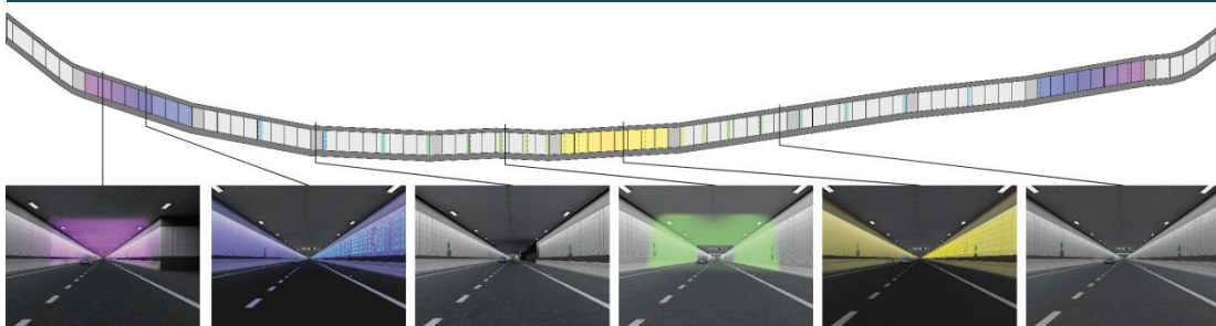
FIGUR 2.23 Principskitse af belysning med farvenuancer
