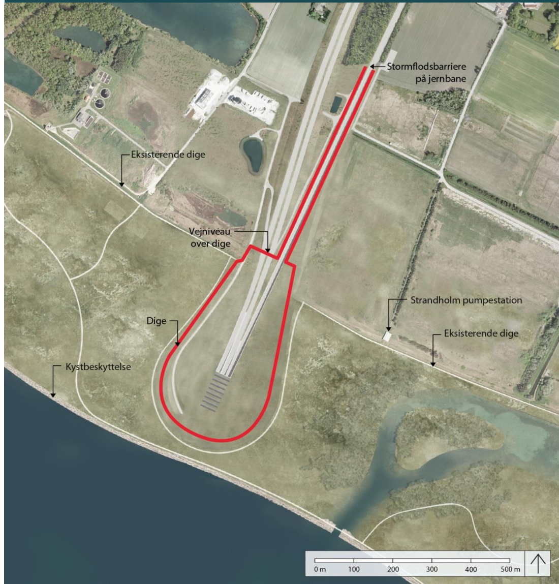
FIGUR 2.27 Portal- og rampeområdets hovedelementer på Lolland
