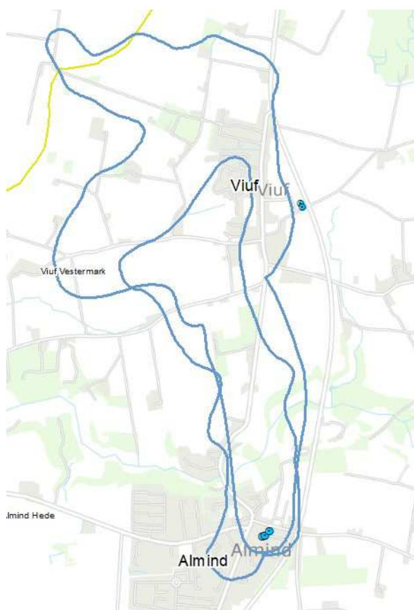
Indvindingsopland for Almind Vandværk beregnet efter trekantsmodel
