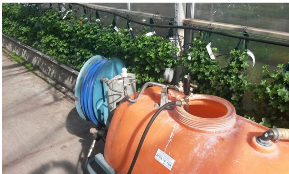
Figur 6. Foto: Niels Enggaard Klausen Sprøjte med spuledyse til at skylle tom emballage
