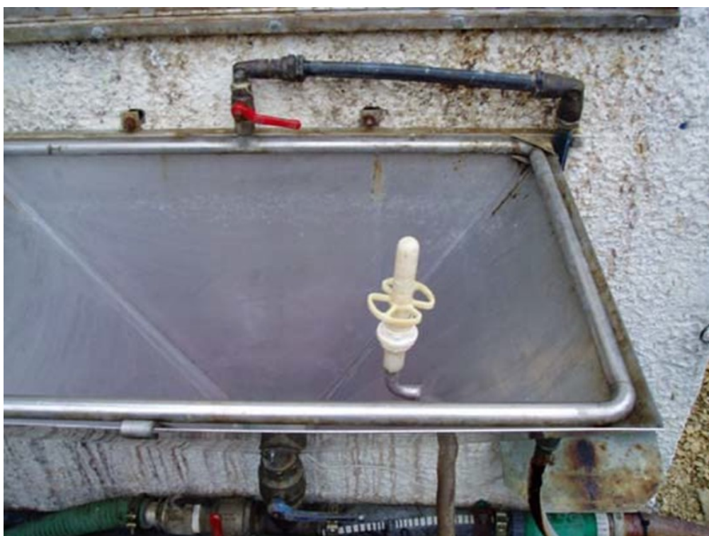
Figur 22. Foto: Poul Henning Petersen Fastmonteret præparatfyld, hvorfra pesticiderne suges op i sprøjtetanken. Enheden er udstyret med spuledyse til Tommy Duke.
