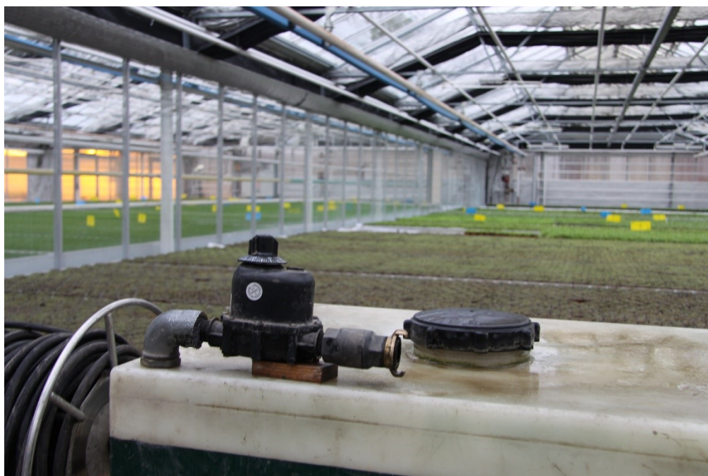
Figur 2. Foto: Niels Enggaard Klausen Kontraventil og vandur på væksthussprøjte
