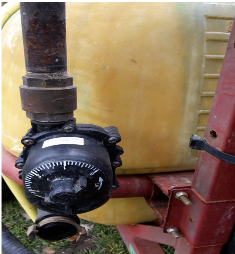
Figur 1. Foto: Niels Enggaard Klausen Kontraventil og vandur på golfsprøjte
