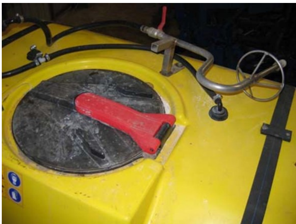
Figur 7. Foto: Niels Enggaard Klausen Tågesprøjte med montering af beholder til skylning af tom emballage. Dunkspuledyse i transportstilling.
