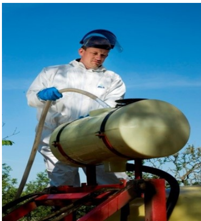
Figur 9. Foto Jens Tønnesen Fotobureau: Landbrugsmedierne Rentvandstank eftermonteret på en marksprøjte
