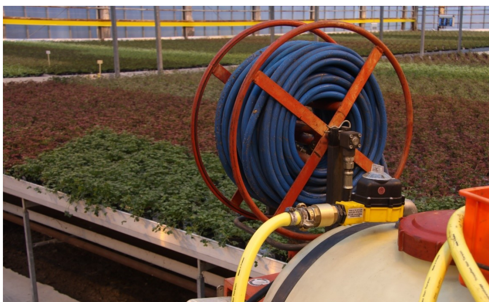
Figur 3. Foto: Niels Enggaard Klausen Kontraventil og vandur på væksthussprøjte
