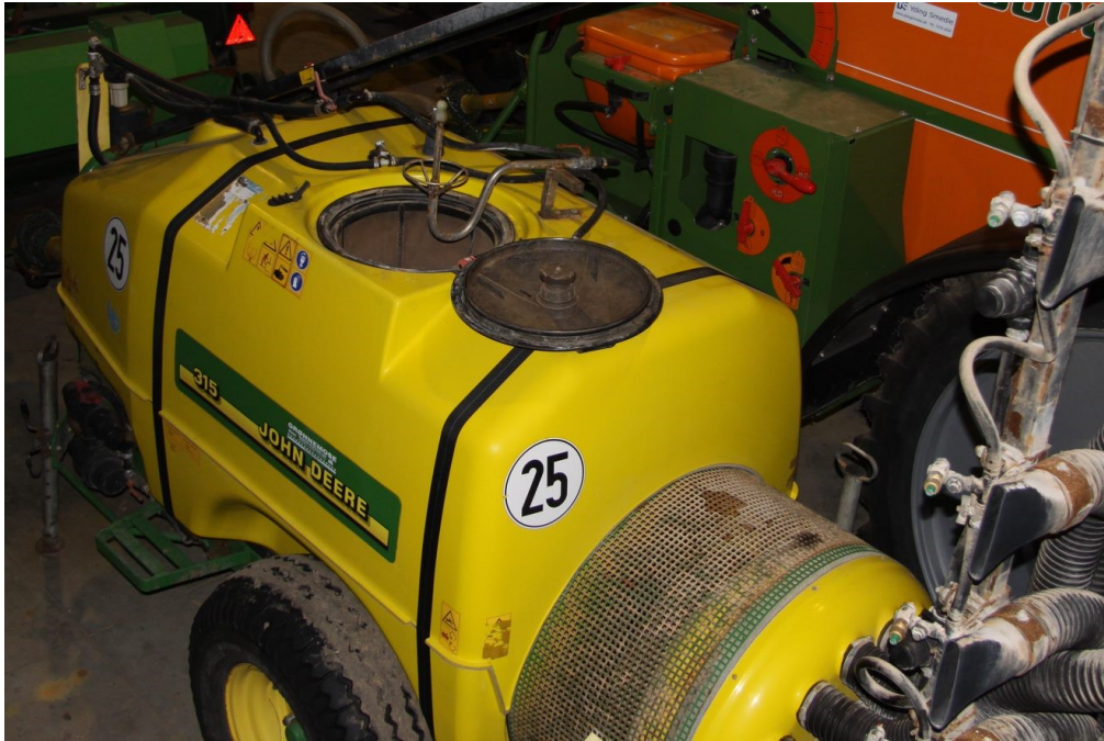
Figur 8. Foto: Niels Enggaard Klausen Tågesprøjte med montering af beholder til skylning af tom emballage. Dunkspuledyse i brugsstilling.
