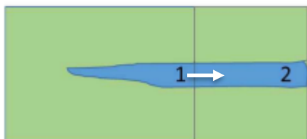
Figur 2: Principskitse for beregning af udjævnet indsatsbehov. Større indsatstryk (kg N/ha landbrugsareal opgjort til rodzonen) til det nedstrøms delopland til kystvand 2 fordeles således, at indsatsstrykket bliver ens i delopland 1 og 2, og således, at indsatsbehovet til begge kystvande dækkes. Indsatsen kan kun udjævnes, hvis nedstrøms indsatstryk er større end opstrøms.
