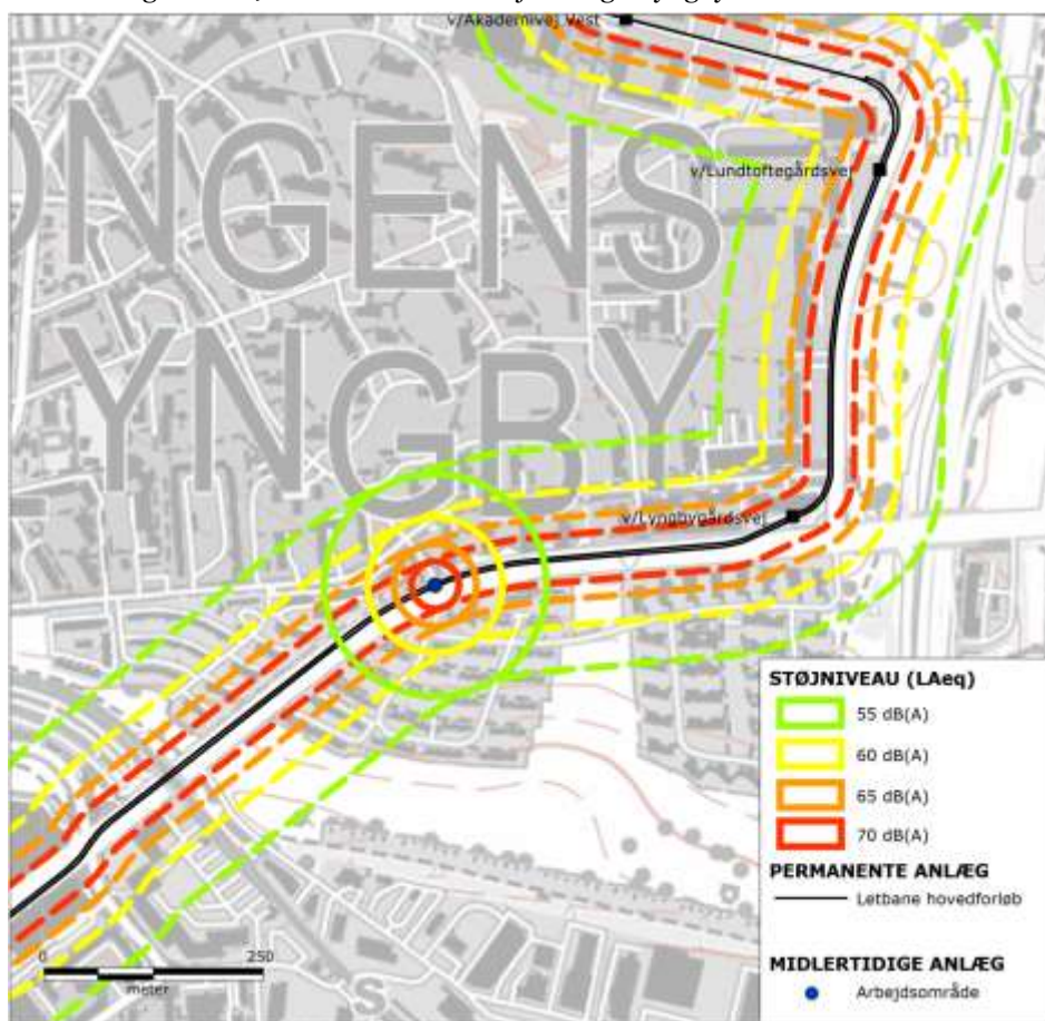
Figur 6.8 | Støj fra etablering af køreledningsanlæg (med boring af fundamenter til køreledningsmaster) for den ændrede linjeføring i Lyngby-Taarbæk Kommune.
