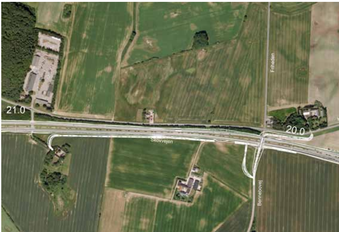
FIGUR 4.5 Bennebovej afbrydes, og der skabes nye adgange til enkeltejendomme. Bennebovej føres over motorvejen som sti
