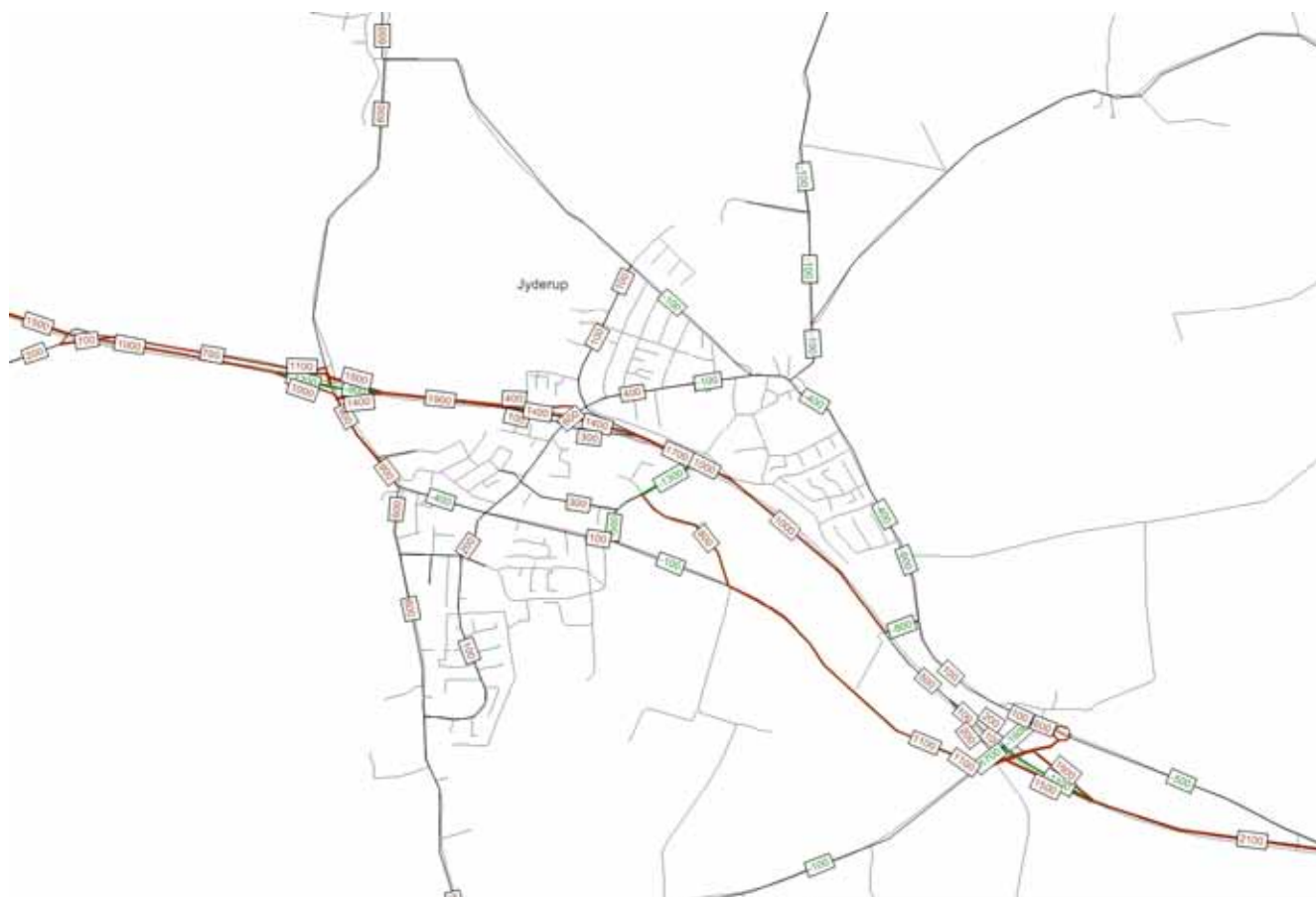
FIGUR 4.28 Forskel i trafik - variant med tre tilslutningsanlæg i forhold til 0-alternativet (årsdøgntrafik i 2020)
