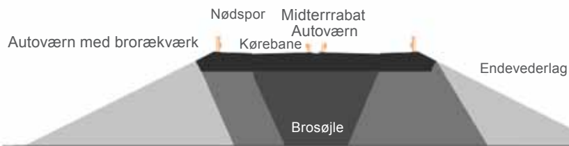
Tværsnit af overføring med trapezformet søjle
