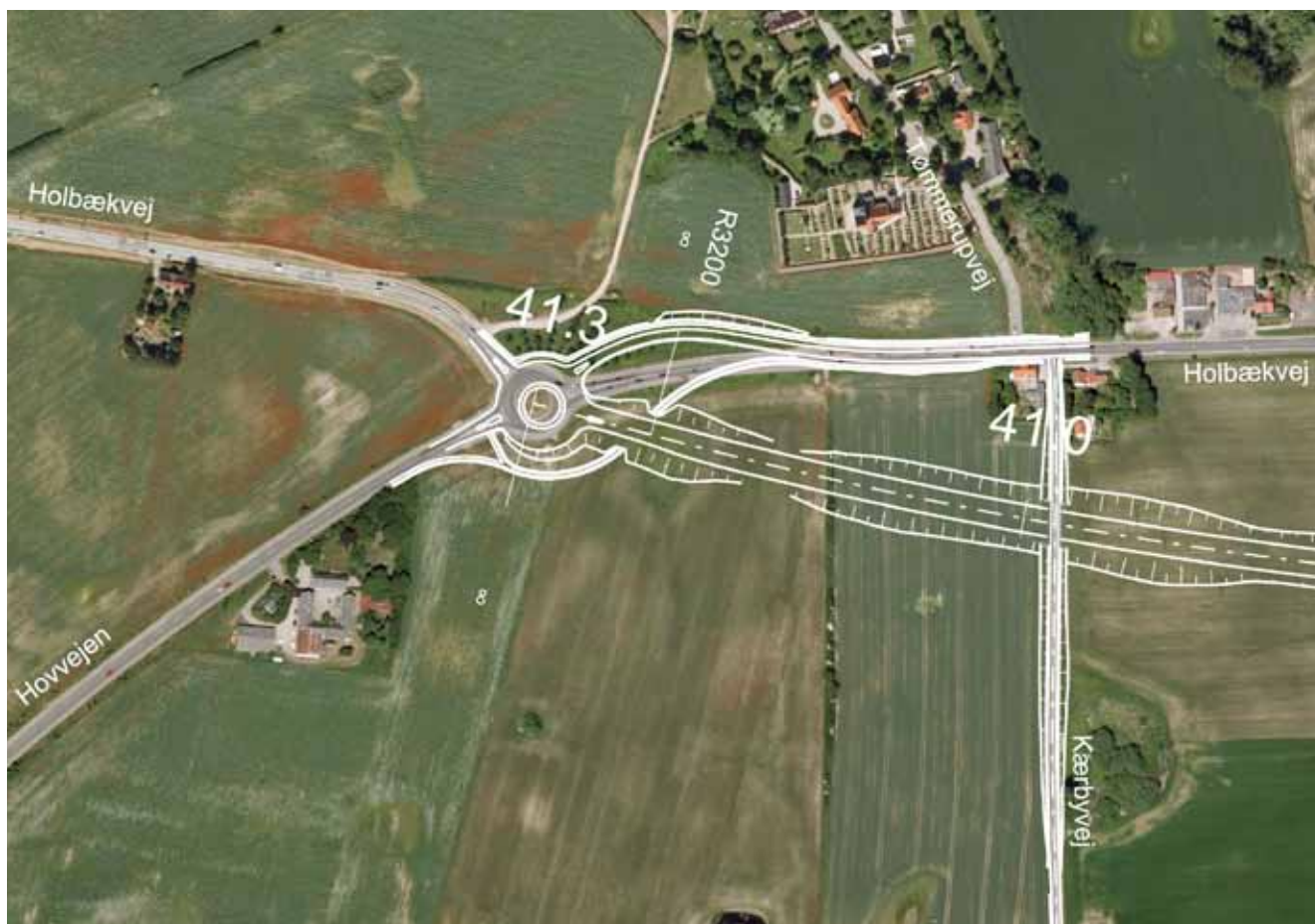
FIGUR 4.17 Afslutningen af motorvejen ved Tømmerup i hovedforslaget
