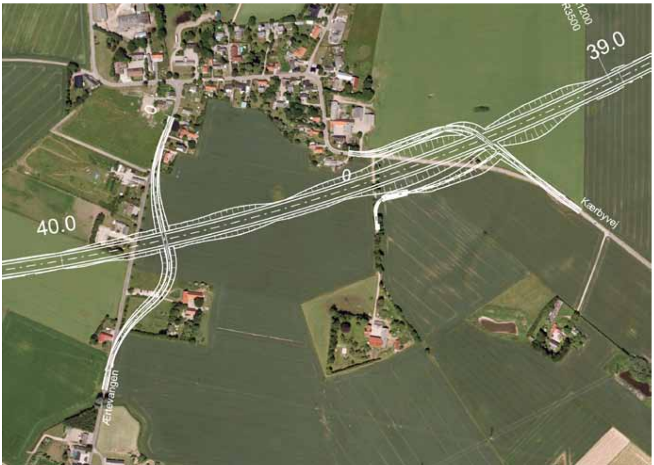
FIGUR 4.22 Kærbyvej og Ærtevangens krydsning af motorvejen i alternativet
