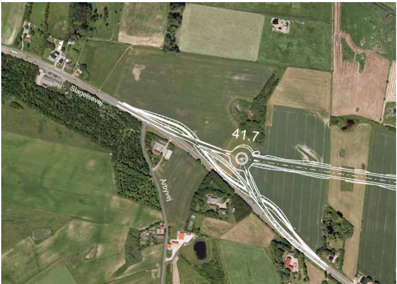
FIGUR 4.23 Motorvejens afslutning ved Slagelsevej i alternativet
