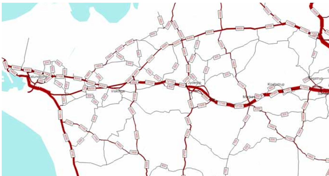
FIGUR 1.5 Beregnede trafikmængder på rute 23 og det omgivende vejnet, ved anlæg af alternativet (Årsdøgns trafik 2020).
