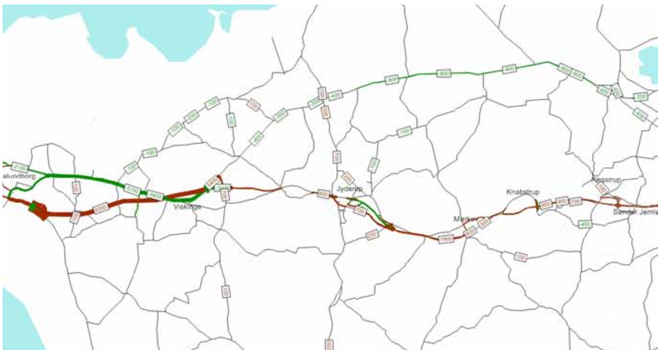
FIGUR 5.7 Forskelle i trafikbelastning mellem alternativet og 0-alternativet. Grønne streger medfører en aflastning og røde medfører en øget trafikbelastning.
