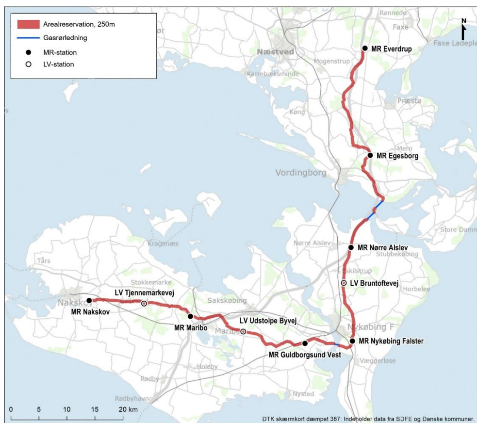
Figur 2-1 Gastransmissionsledning og gasdistributionsledning med tilhørende linjeventil- og MR-stationer. Arealreservationen gælder i et bælte på 250 m på hver side af den planlagte gasrørledning på land.
