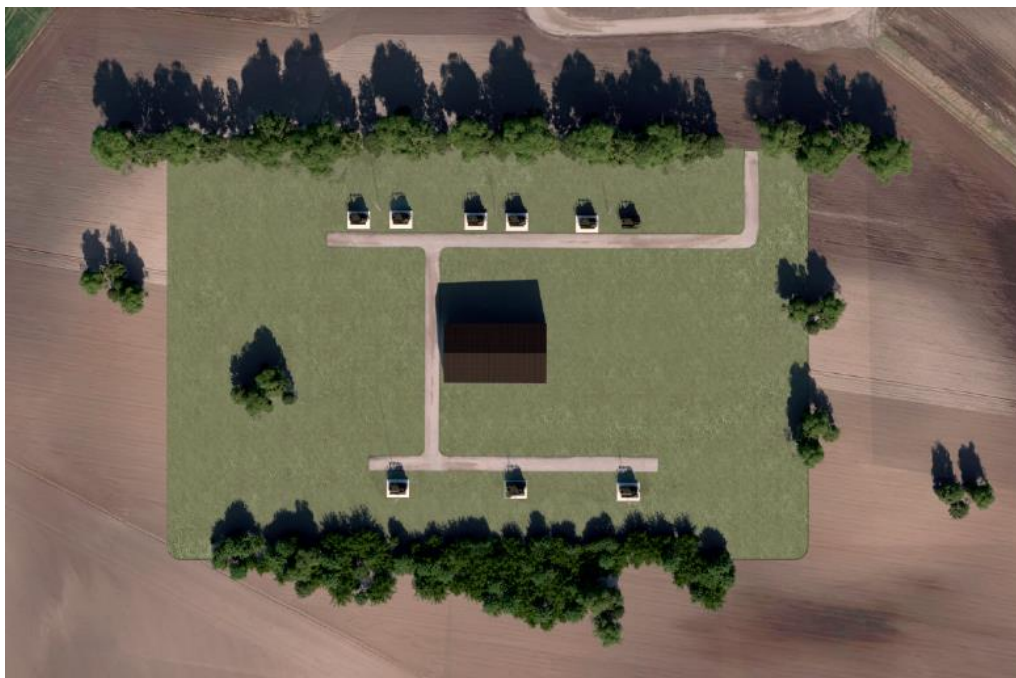
Figur 7.15 Et eksempel på, hvordan en ny højspændingsstation kunne indrettes med GIS-bygning, lynafledere og kompenseringsspoler.
