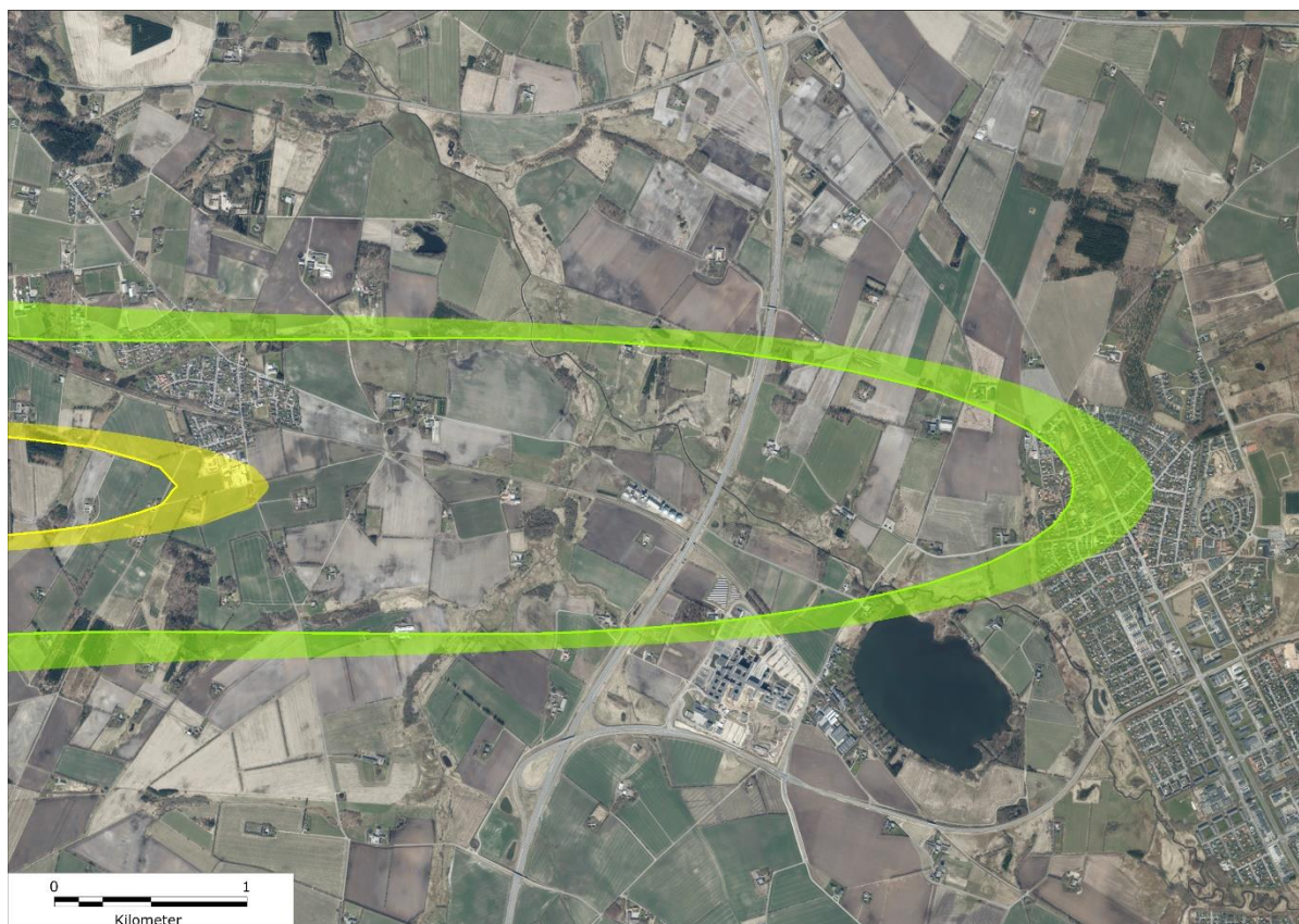
Figur 9-5. Udsnit af Figur 9-4, der viser ændringer af støjkonturerne for en fiktiv lufthavn. Det gule område viser forskellen mellem støjkonturer for L_{DEN} 55 dB beregnet i henhold til den eksisterende vejledning og ECAC Doc. 29, 4. udgave. Tilsvarende viser det grønne område forskellen for L_{DEN} 50 dB. Den vejledende grænseværdi for en lufthavn er L_{DEN} 55 dB for boligområder o. lign. og 50 dB for rekreative områder med overnatning.
