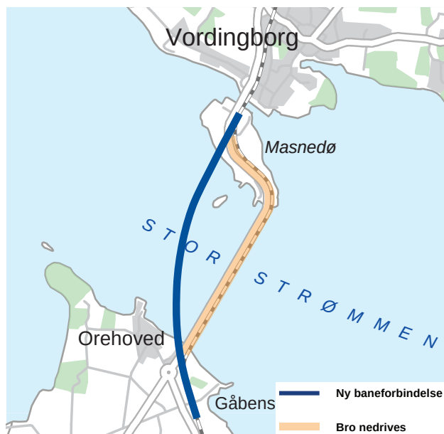
Figur 3.6 Ny jernbanebro og nedlæggelse af vejforbindelsen på den eksisterende bro
