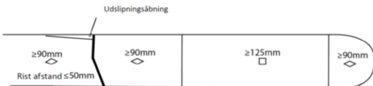
Figur 8: Skematisk oversigt over den horisontale sorteringsrist med højst 50 mm mellem tremmerne.
