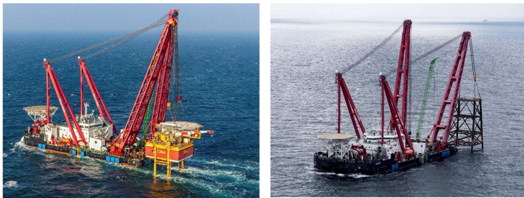
Figur 6-17 Eksempel på transport af topside og jacket i kran krog.
