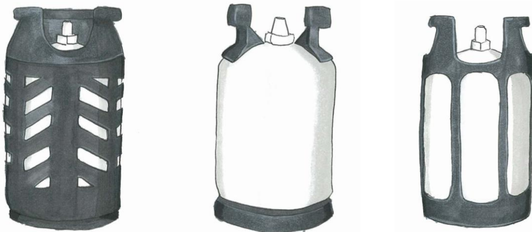
Figur 3: Illustration af kompositflasker med plastkomponenter, der ikke er at opfatte som brændbar emballage.
