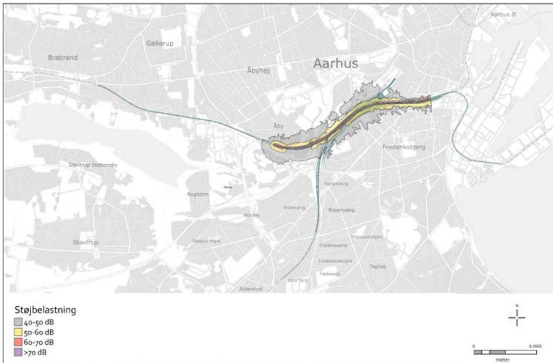
Figur 1-11 Støjdbredelsen i natperioden ved udførelse af køreledningsarbejder i spor 20/30, 100% drift. Ingen korrektion for støjens karakter
