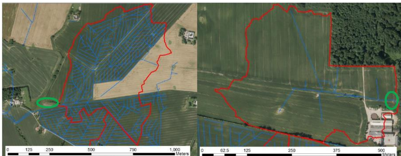
Figur 1 Eksempler på afgrænsning af drænoiland for henholdsvis et systemdrænet drænoiland (venstre billede) og et punktdrænet oiland (højre billede). De grønne cirkler markerer, hvor der er placeret et minivådområde.
