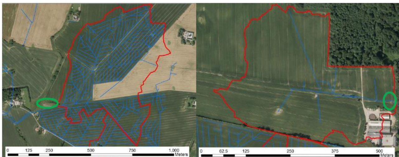
Eksempler på afgrænsning af drænoiland for henholdsvis et systemdrænet drænoiland (venstre billede) og et punktdrænet opland (højre billede). De grønne cirkler markerer, hvor der er placeret et minivådområde.
