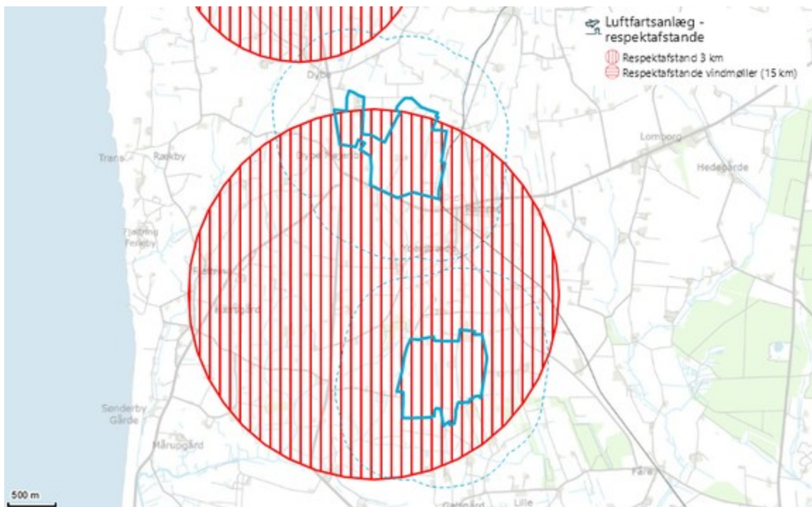
Figur 38: Overlap mellem energiparken og respektafstande til luftfartsanlæg
