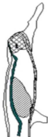
Figur 3. Illustration af svabersteder for særslagningsprøver. (Det krydsskraverede areal svabres med en gazetampon, som beskrevet i afsnit 8.5)
