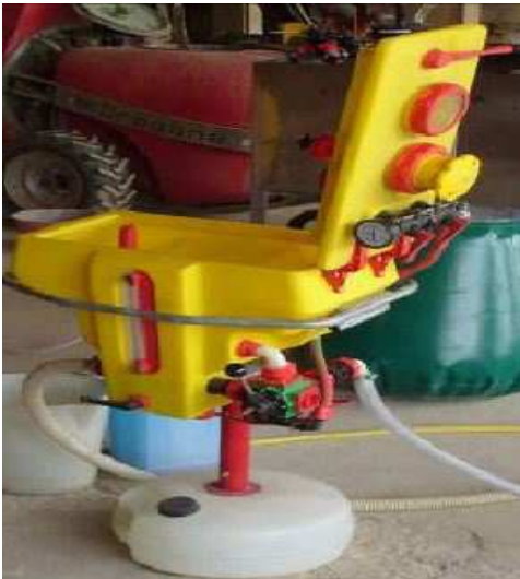
PRÆPARATFYLDEUDSTYR, HVORFRA SPRØJTEMIDLERNE SUGES OP I SPRØJTEN
