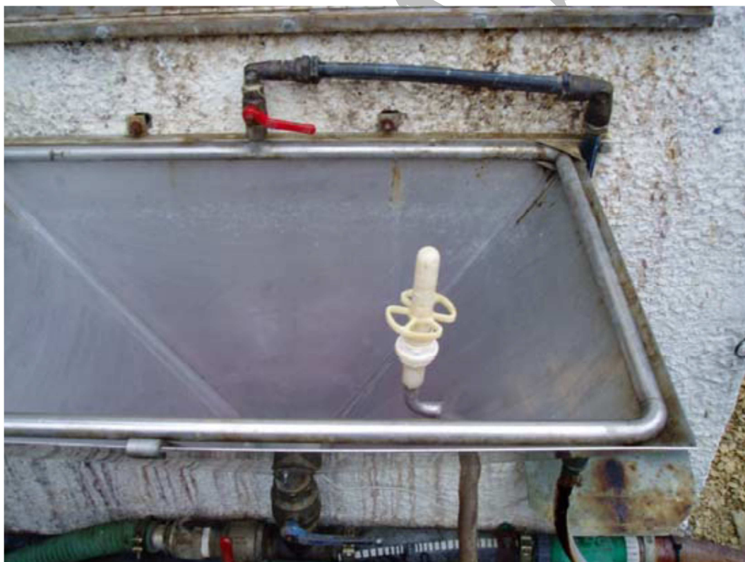
FAST MONTERET PRÆPARATFYLD, HVORFRA SPRØJTEMIDLERNESUGES OP I SPRØJTETANKEN. ENHEDEN ER Udstyret med spuledyse til tomme dunke FOTO: POUL HENNING PETERSEN
