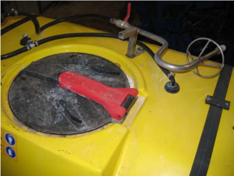
TÅGESPRØJTE MED MONTERING AF EN UDVENDIG SPULEDYSE, DER GØR DET MULIGT AF SKYLLE TOM EMBALLAGE. PÅ GRUND AF SPRØJTENS RINGE STØRRELSE KAN PÅFYLDNING AF KONCENTRERET BEKÆMPELSMIDDEL OG SKYLLEVAND SKE DIREKTE Gennem ÅBNINGEN I SPRØJTETANKEN FOTO: NIELS ENNGAARD KLAUSEN
