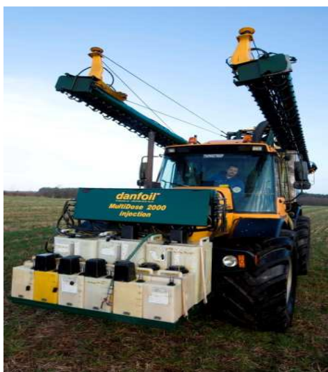
MARKSPRØJTE MED INJEKTIONSSYSTEM FOTO: JENS TØNNESEN, LANDBRUGSMEDIERNE
