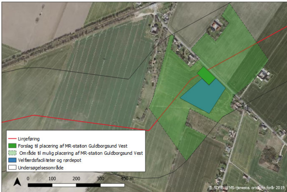
Figur 6 Forventet placering og område til mulig placering af MR-station Guldborgsund Vest ved Møllevvej ved Toreby. Nærmeste nabo er Møllevvej 20. Arealet i det blå område forventes anvendt som rørdepot og velfærdsfaciliteter i anlægsfasen.
